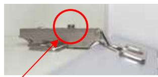
左右調整ネジが3mm以上突起しているとダンパーが干渉する。
